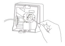
4 Nach Einsetzen der Gummiabdeckung 3 bauen Sie die Abdeckung des PM1.0-Sensors 2 ein.
