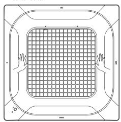
Befestigen Sie die Oberseite des vorderen Gitters, indem Sie auf die Griffe drücken.
