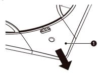
2 Entfernen Sie nach dem Öffnen der Abdeckung des PM1.0-Sensors 2 die Gummiabdeckung
