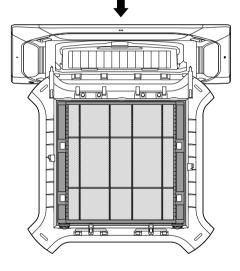
2 Drücken Sie auf die Laschen 2 an beiden Seiten und lösen Sie das untere Ende des Luftfilters vom vorderen Gitter.
