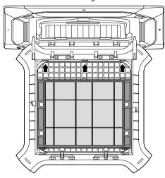
5 Setzen Sie die Laschen in die Befestigungsöffnungen an der Unterseite des vorderen Gitters ein.
