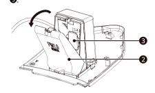
3 Wischen Sie anhaftenden Staub mit einem leicht mit Wasser angefeuchteten Wattestäbchen von der Linse. Wischen Sie diese danach erneut mit einem trockenen Wattestäbchen ab, um die Feuchtigkeit zu entfernen.
