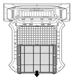
4 Drücken Sie auf den Befestigungsgriff 3 und ziehen Sie die Oberseite des PM 1.0-Filters nach unten.
