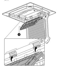
3 Drücken Sie die Oberseite des PM 1.0-Filters nach oben und befestigen Sie ihn am Gerät.
