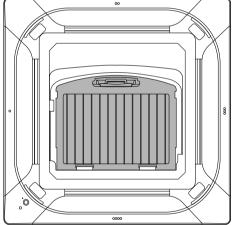
4 Setzen Sie die Haken an der Oberseite des Luftfilters in die Öffnungen ein.
